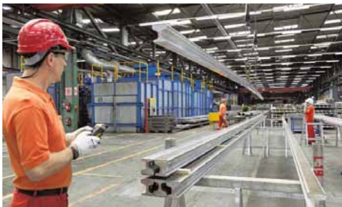
Diese „frisch gepressten“ Verbundstromschienen werden in naher Zukunft in Bangalore für den Bau der U-Bahn verwendet. BILD: TESCHÉ
