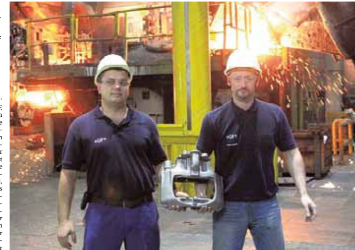
Der Produktionsmitarbeiter Alexander Weizel, links, und Teamleiter Peter Lauber präsentieren stolz den 22,1 Kilogramm leichten Bremsattel aus Sphäroguss, der in der Gießerei von GF in Singen hergestellt wird und Herstück weltweit gefragter LKW-Scheibenbremsen ist. BILD: TESCHKE
