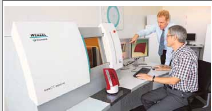
Dieser Schreibtisch mit den Monitoren und dem Computertomographen ist ein komplettes Produkt der Wenzel Volumetrik GmbH. Er wird als kompakte Workstation konzipiert und verkauft. Neben der Workstation gibt es noch zwei kompakte Tischgeräte. Hier bespricht Geschäftsführer Rainer Goerke (43, Softwareentwickler) das Messergebnis eines Pkw-Rücklichtes. BILD: SABINE TESCH
