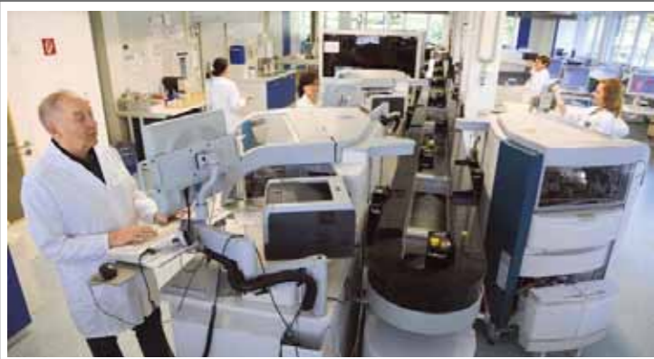
Diese vollautomatische Analysenstraße arbeitet rund zwölf Stunden täglich. In dieser Zeit werden hier bis zu 15 000 Analysen durchgeführt. Die Anlage wurde 2009 installiert. Bis dahin wurden Untersuchungen an Einzelgeräten vorgenommen. Die zunehmende Zahl der Proben machte eine Steigerung des Automatisierungsgrades erforderlich. BILD: DS
